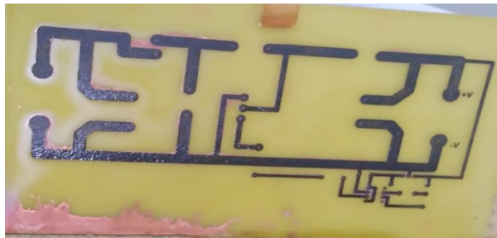
Figure IV- 13 La plaque après avoir été placée dans perchlorure de fer ( \text{FeCl}_3 )
