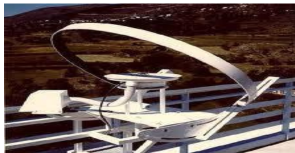
Figure II-4 : Appareil de mesure des rayons diffus (pyranomètre) [21].
