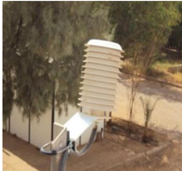
Figure II-8 : Appareil de mesure de la température (thermocouple) [21].
