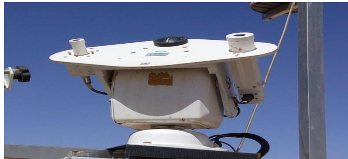
Figure II-3 : Appareil de mesure des rayons directs (pyrhéliomètre) [22].
