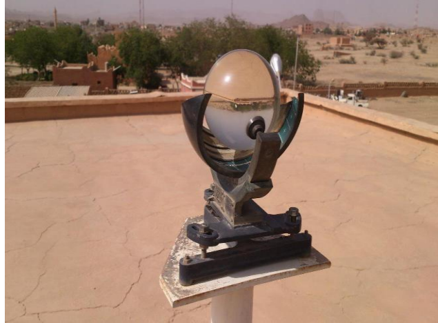
Figure II-7 : appareil de mesure de la durée d'insolation (héliographe) [22].
