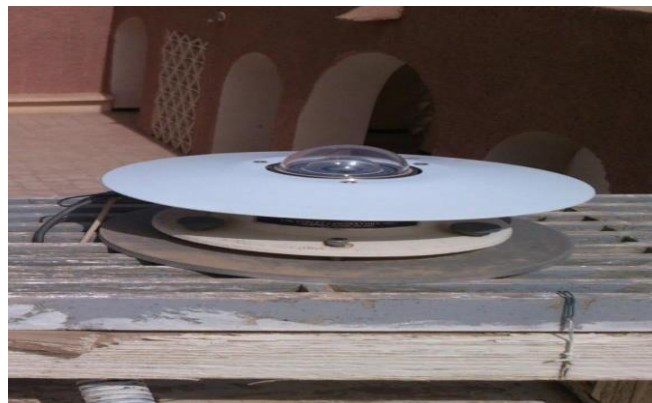
Figure II-6 : Pyranomètre: appareil de mesure des rayons diffus [22].
