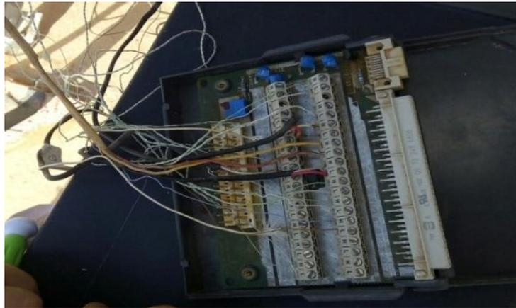
**Figure III.6 :** Les thermocouples placés dans le module
