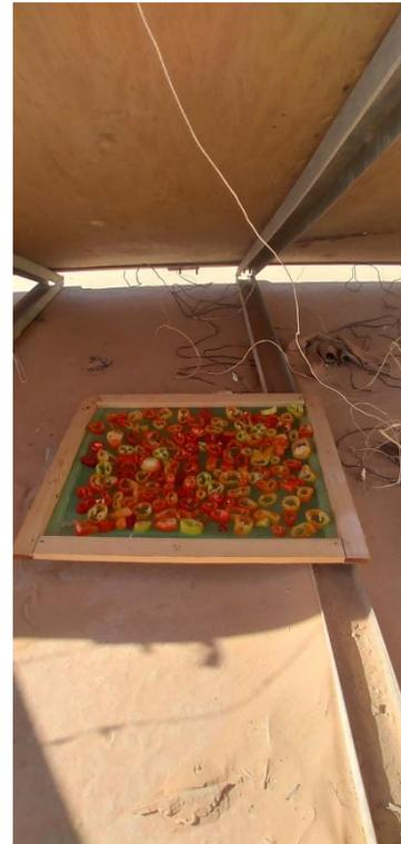
**Figure III.4 : Installation des claies pour le séchage**
