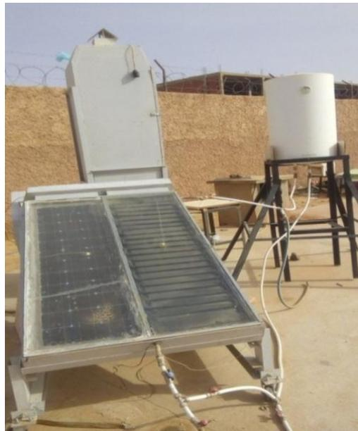
**Figure III.2** : Séchoir solaire indirect à l'URERMS Adrar
