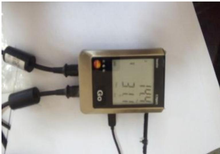
**Figure III.7 :** Appareil thermo et hygromètre Testo H176
