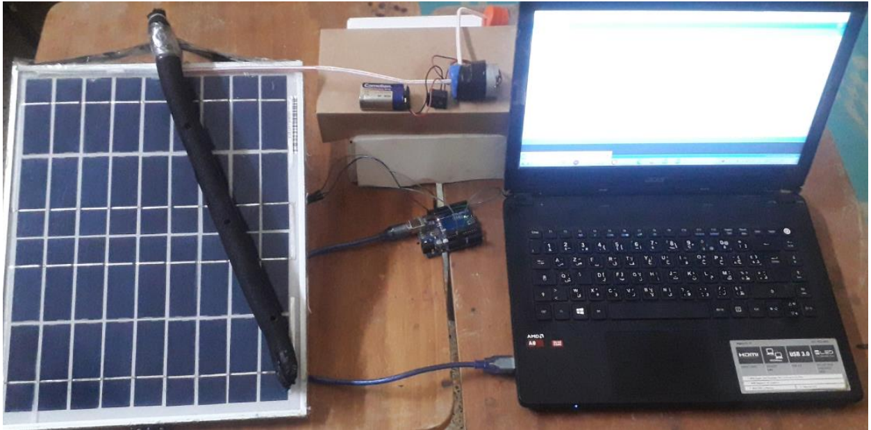
Figure III.38: Système de nettoyage robotique.
