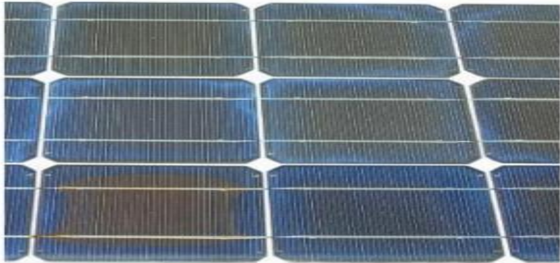
Figure II.8: Module présentant une décoloration[31].
