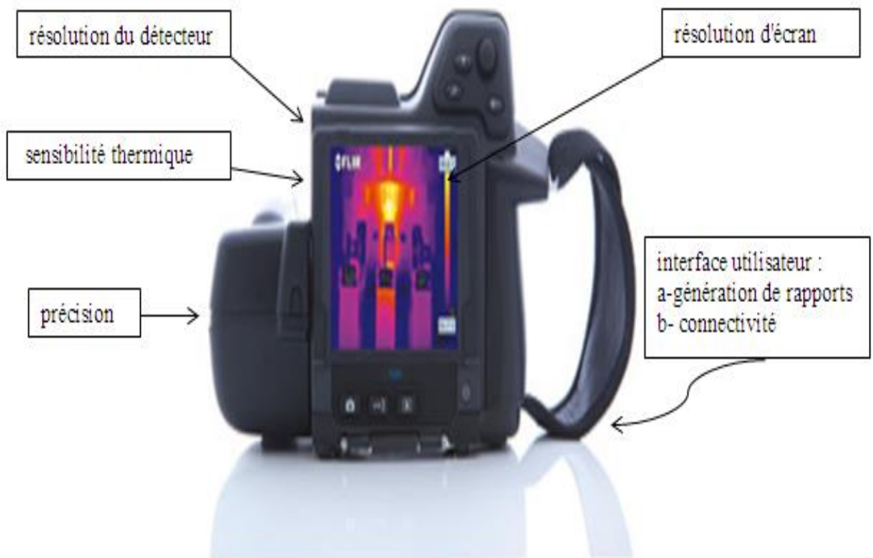
Figure III.20: Quelques caractéristiques importantes du système de caméra infrarouge pour les applications photoélectriques [28].
