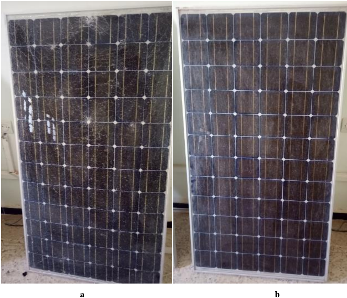
Figure III.13: Module ISOFOTON 100: a-Module défaut casse, b-Module défaut Décoloration.
