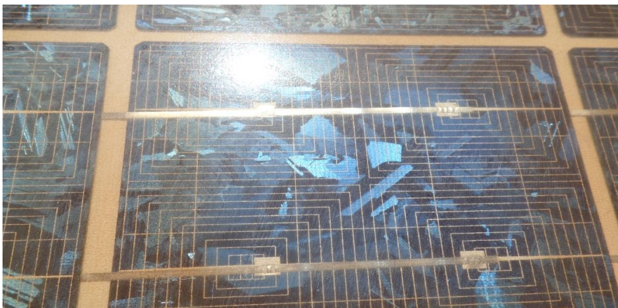
Figure III.11: EVA Décoloration et Corrosions.
