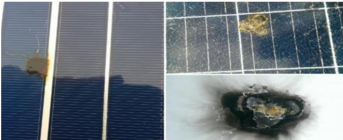
Figure II.10: Défaut de point chaud[1][10].
