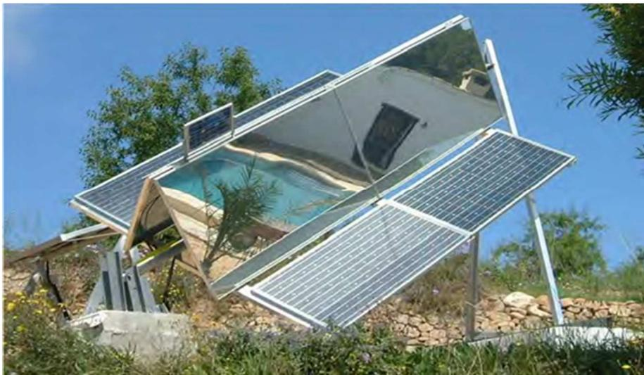
**Figure 3. 10** Capteur à renforcement du rayonnement [62].
