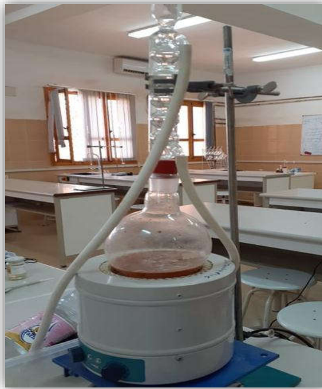
Figure 33 : Montage du chauffage à reflux.
