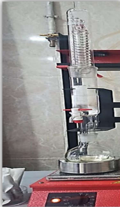
Figure 29 : Appareil de Soxhlet pour l'extraction de la matière grasse.
