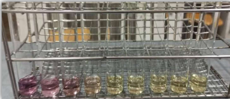
Figure 37 : Mesure du pouvoir antioxydant par le test de DPPH.
