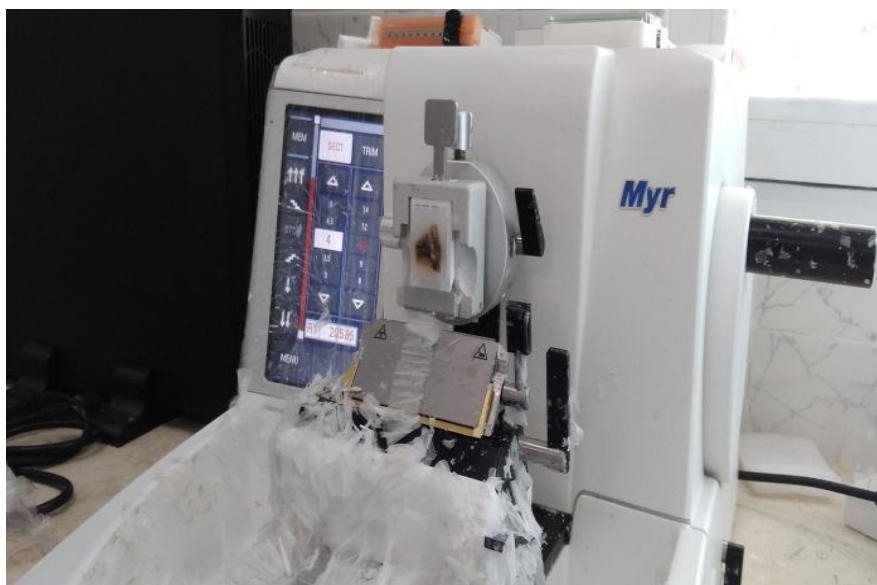
Figure 21 : La réalisation d'un ruban renfermant une coupe histologique au microtome
