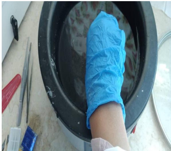
Figure 22 : Etalement d'un ruban, récupération sur lame d'une section de coupe
