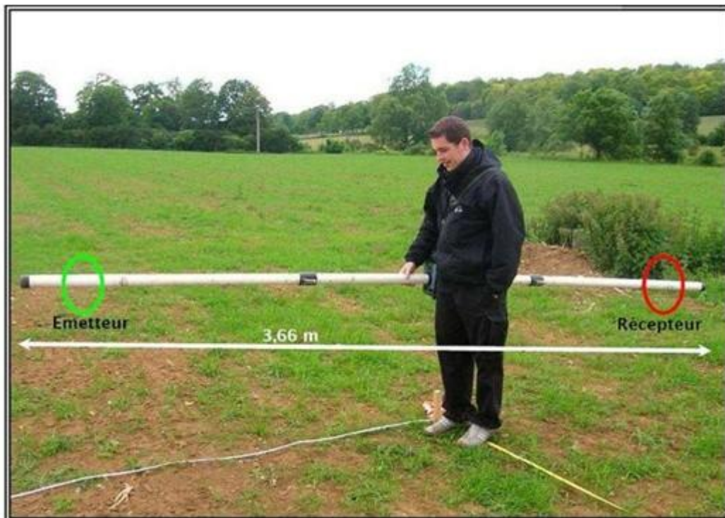
FIGURE II. 6: Dispositif EM31 (Stage de Géophysique de Polytech' Paris (2006))
