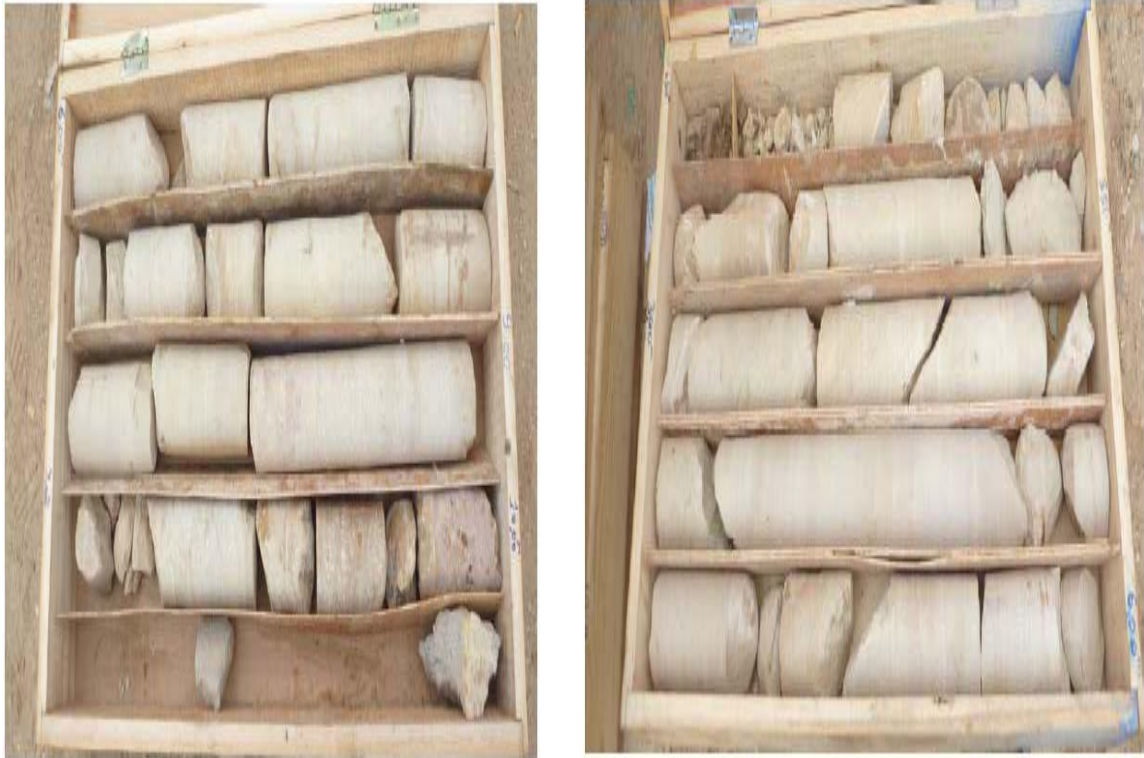
Photo II.2 : Sondage SC-205 entre 0 m et 10 m de profondeur. Détail du groupe géotechnique Ct, grès fin à très fin, avec ciment siliceux.
