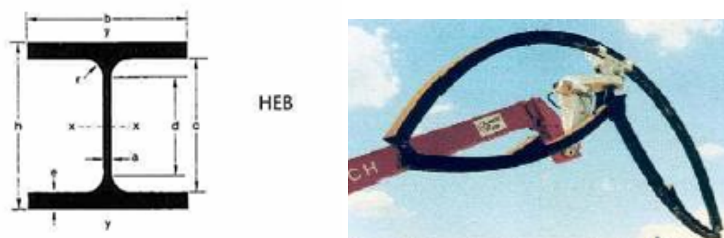
Figure I.8: cintres métalliques lourds [9]
