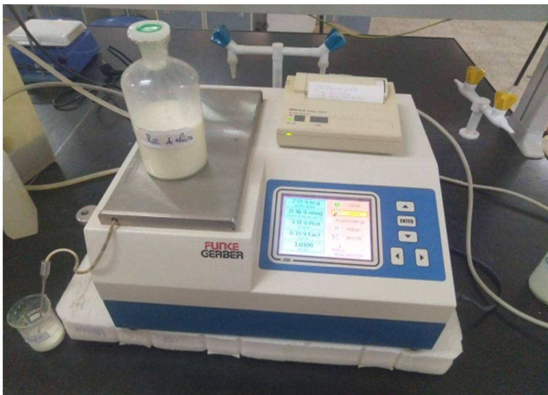
Figure09 : Appareil de lactoStar
