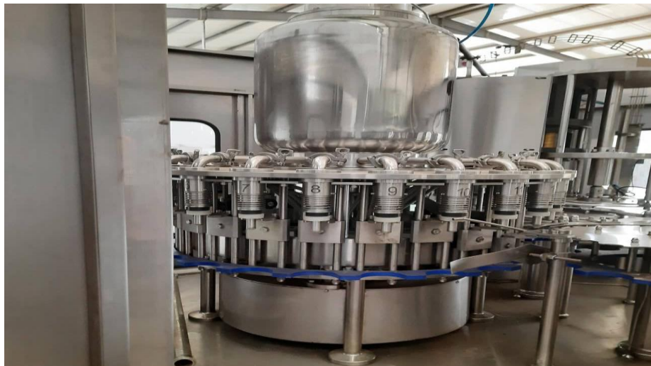
Vue intérieure de la machine de remplissage de bouteilles en plastique.
