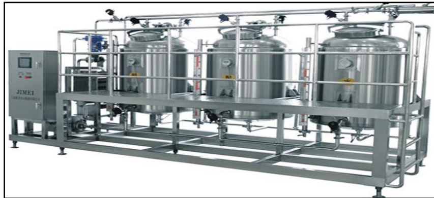
Figure 21: Système de nettoyage et de désinfection automatique (CIP)
