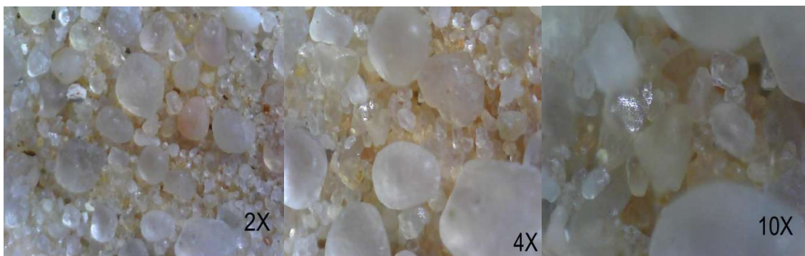
Figure IV.12 Images de l'échantillon (03) après traitement chimique avec H 2 O 2
