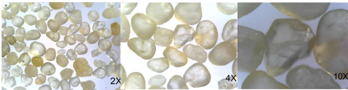
Figure IV.15 Images de l'échantillon (04) après traitement chimique avec H 2 O 2
