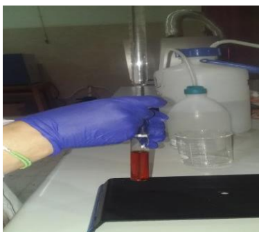
Figure 20: Ajout de 10 ml d'eau distillée après la sortie du bain de refroidissement.
