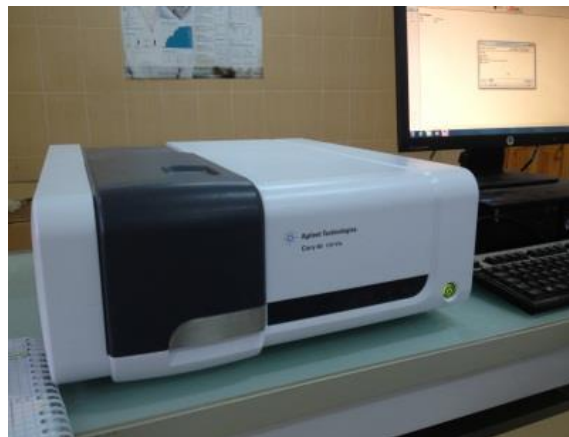
Figure 15: Lecture au spectrophotomètre UV. Visible (Cary 60 Agilent).
