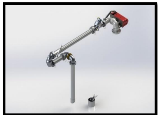
Figure 51 : Bras de chargement 3 e
