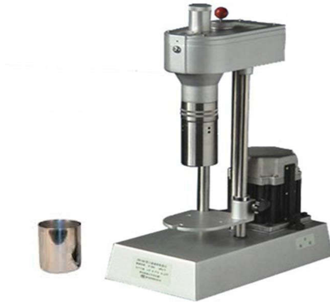
Figure III.5 : Viscosimètre cylindre fann [17].
