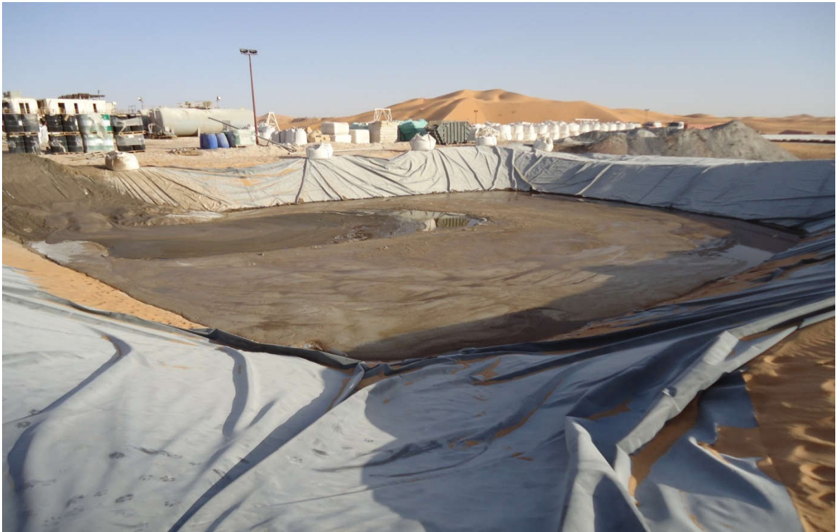
Photo II.2 : Bourbiers après l'avancement des opérations de forage.
