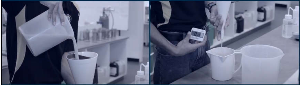
Figure IV.2 : Matériel méthode de mesure de viscosité Marsh.
