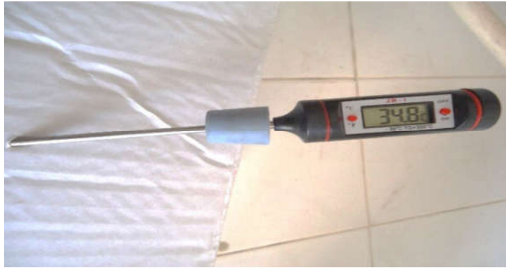
Photo IV.2 Thermomètre électrique (Laboratoire de l'unité de recherche sur les énergies renouvelables en milieu saharien).
