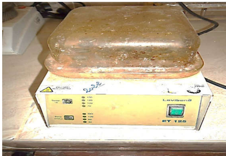
Photo IV.7 DCO-mètre (Laboratoire de l'unité de recherche sur les énergies renouvelables en milieu saharien)
