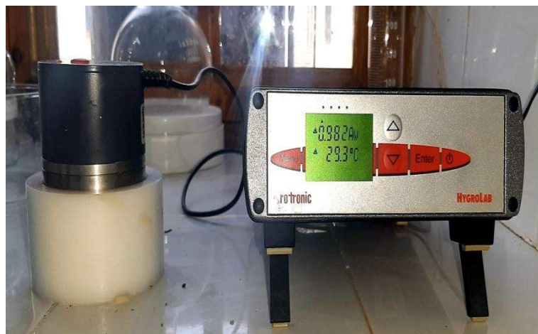
Appareil HygroLab pour mesurer l'activité d'eau
