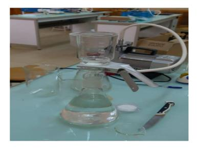
Figure 19: Dispositif de filtration sous vide.
