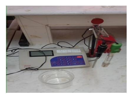
Figure 5 : Détermination de pH à l'aide d'un pH-mètre.
