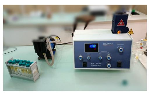
Figure 15: Photomètre à flamme.
