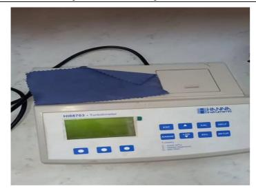
Figure 9 : Détermination de la turbidité à l'aide d'un turbidimètre.
