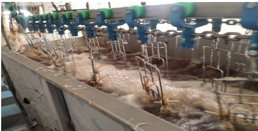
Figure 16 : Bassin d'échaudage des poulets (source enquête)
