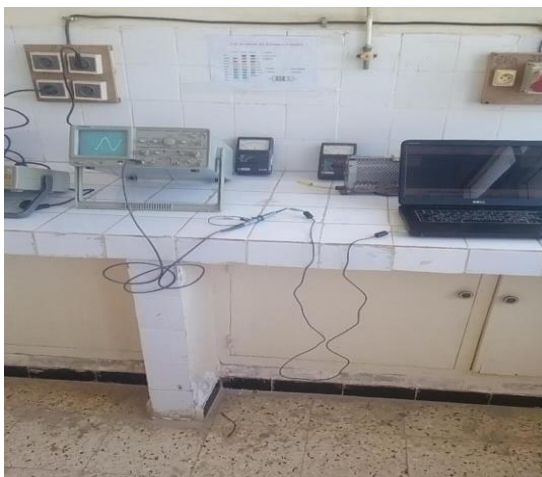
Figure 2 : Montage de la caractérisation du signal de son
