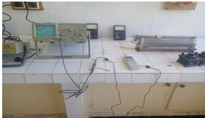
Figure 1 : Montage de caractérisation du signal de bruit
