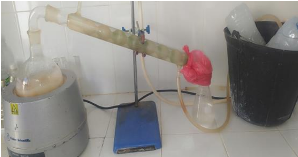
Figure III.11 Le Clevenger (hydrodistillateur standardisé)
