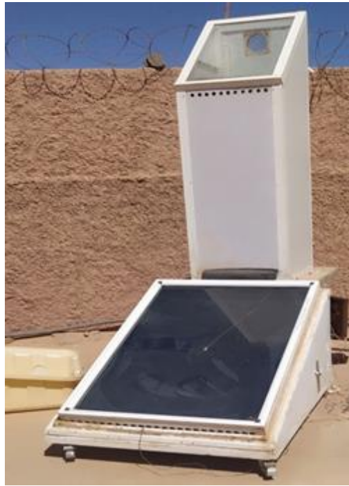
Figure III.2 : Séchoir solaire indirect à l'URERMS Adrar
