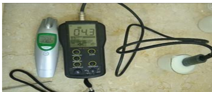
Figure 17 : Mesure de la conductivité électrique à l'aide d'un Conductimètre (HI 8733)
