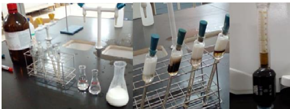
Figure 15 : Préparation des échantillons et la lecture de résultat sur le butyromètre.
