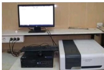
Figure II.1 : Spectrophotomètre UV-Visible utilisé.
