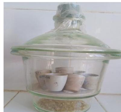
**Figure 08 :** Échantillons dans un dessiccateur.
