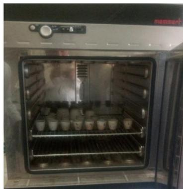
**Figure 07 :** Échantillons dans une étuve réglée à 105°C.
