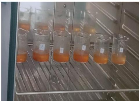
**(a) :** Echantillons dans 20ml d'acide sulfurique (0.5M), placés dans une étuve à 105°C pendant 3 heures.
