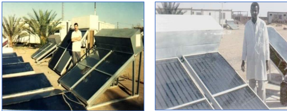
Figure II. 30 :Photo représentant les CES CDER en plein test sur la plateforme d'essai SEESMS.
