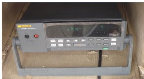
Figure V. 39 : Photo représentant l'acquisition de données utilisée pour la lecture et le stockage des paramètres mesurés.
