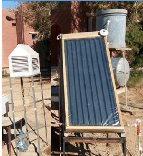
Figure V. 16 : Test de capteur avec couverture transparente en plastique.
