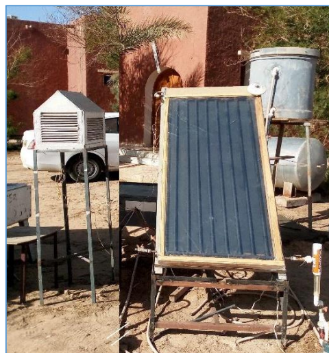
Figure V. 28: Photo représentant le capteur en couverture de Verre.
