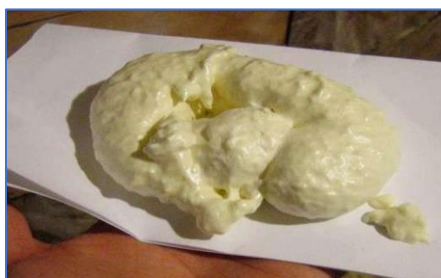
Figure IV. 8 : Photo représentant l'isolation polyuréthane.
