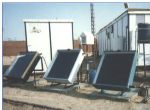
Figure II. 4 : Configuration d'un chauffe-eau solaire (Autostockeur)
