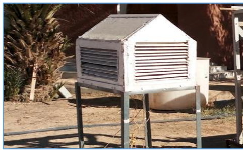
Figure V. 40 : Photo représentant l'abri pour la mesure de la température ambiante.
