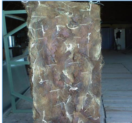
Figure V. 7 : Panneau de lif (FDEM) installé dans le capteur.
