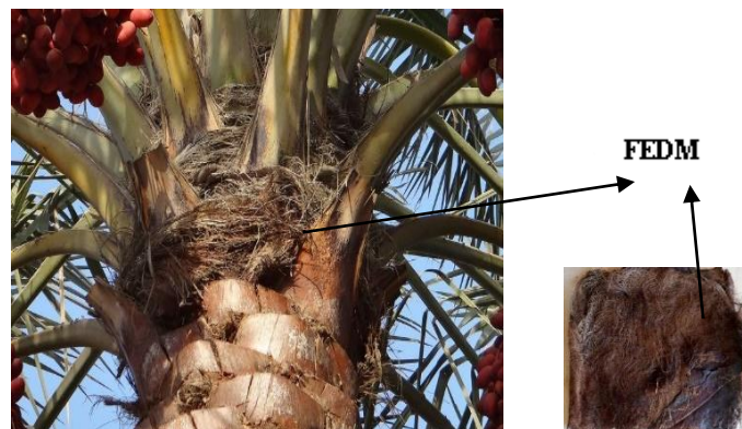
Figure V. 6 : La fibre de palmier utilisée comme isolant thermique dans le capteur.
