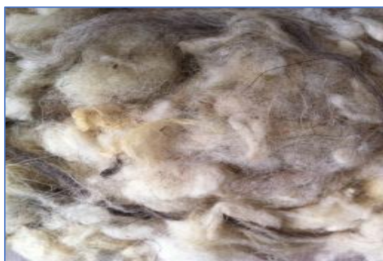
Figure IV. 6 : Photo représentant l'isolation de laine de mouton.
