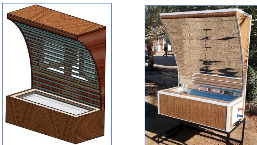
Figure II. 6: Le chauffe-eau solaire stockeur intégré à l'habitat.
