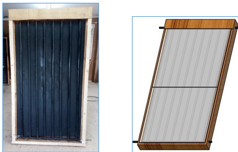
Figure V. 13: Photo représentant le capteur solaire installé sur la plate-forme des essais de l'URER/MS [2].
