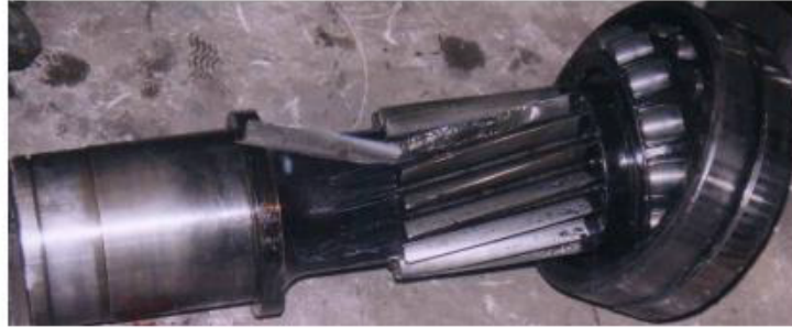
Figure III.1.dents du pignon intermédiaire cassées à la suite d'arrêts et de démarrages fréquents de l'éolienne [4]
