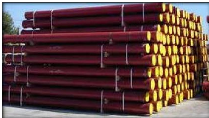
Figure 7 : Tuyaux en fonte ductile [7] .
