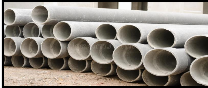
Figure 10 : Tuyaux en amiante-ciment [8].
