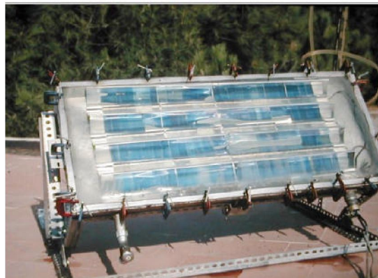
Fig. 2.9 - Le prototype du concentrateur statique CPV construit à l'UPM avec des cellules PV bifaciales. Universidad Politécnica de Madrid.
