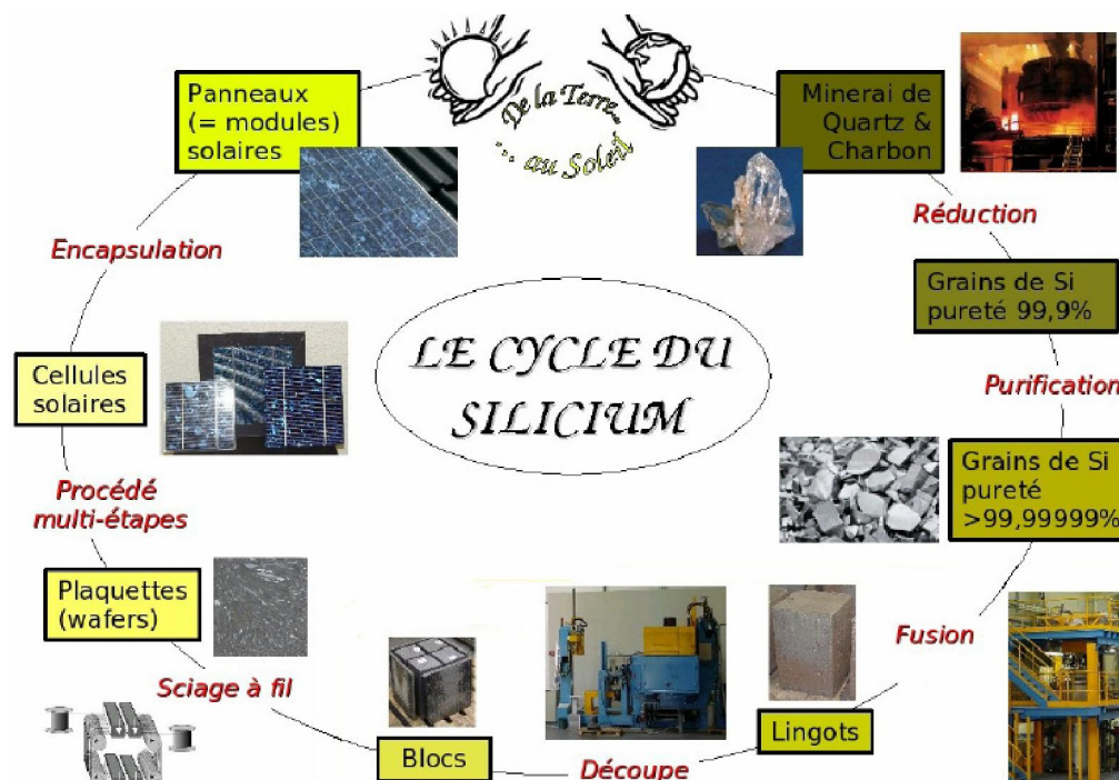
Fig. 2.4 - La Chaîne de Valeur Photovoltaïque (technologie cristalline) [26].
