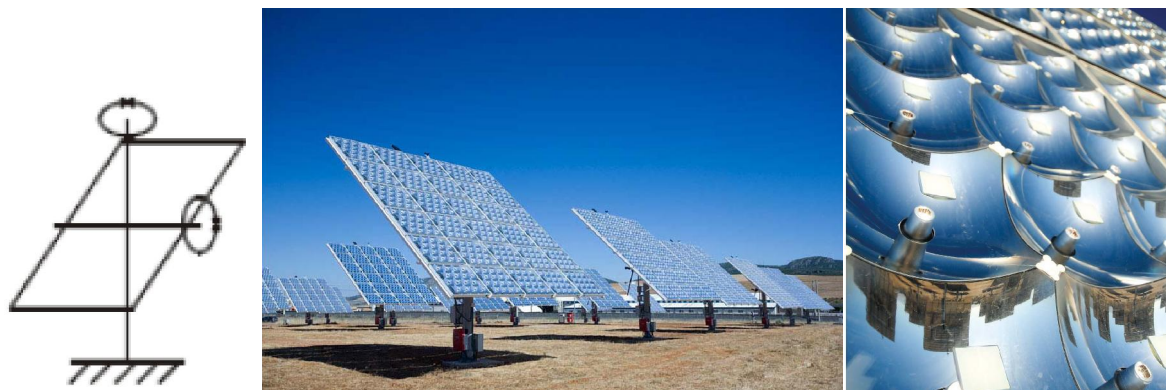
Fig. 2.34 - Schéma de principe d'un suiveur du soleil à deux axes et photos d'un système CPV de la technologie SolFocus utilise ce type de suivi [32].
