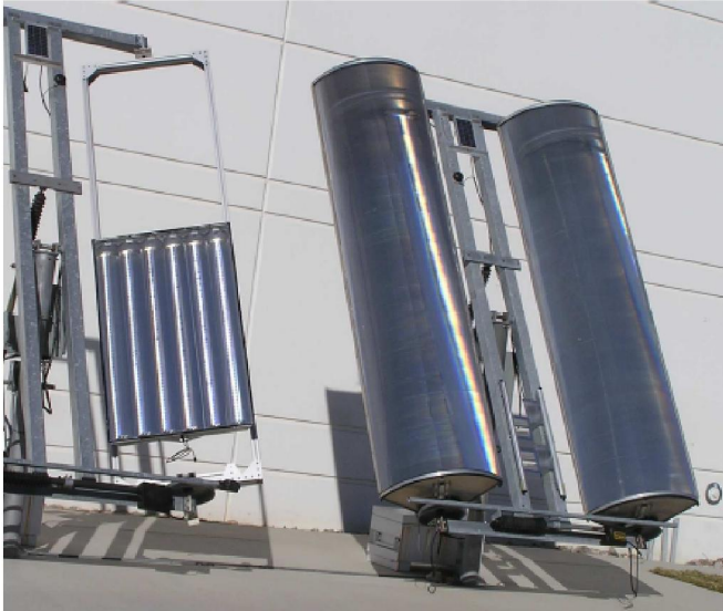
Fig. 2.41 - Système MCPV Entech, le nouveau SolarVolt à gauche 204Wc DC et l'ancien à droite 694 Wc DC (STC). Photo [101].
