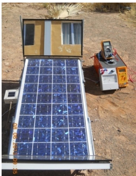
Fig. 4.17 - Vue du système réalisé LCPV V-trough. Université de Béchar.
