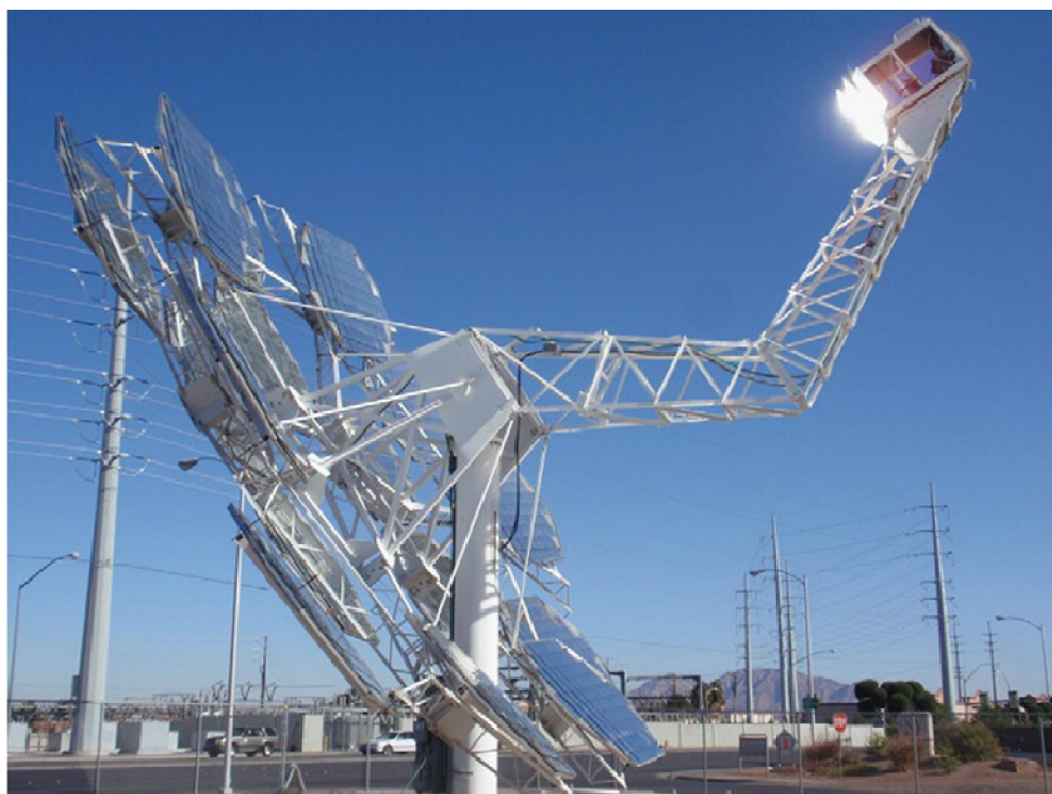
Fig. 2.25 - Le système CPV à concentrateur parabolique. University Nevada, Las Vegas, USA [45].
