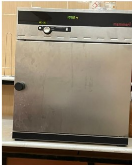
Figure III. 6: Etuve pour séchage et matière sèche.
