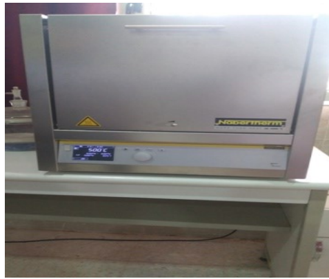
Figure III. 5: Four à moufle utilisée (NABERTHERM L1/12 - LT 40/12).
