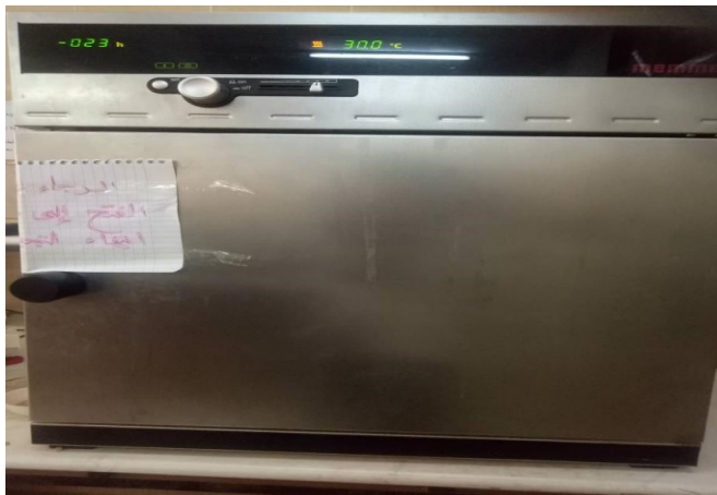
Figure III. 3: Etuve pour séchage et matière sèche.
