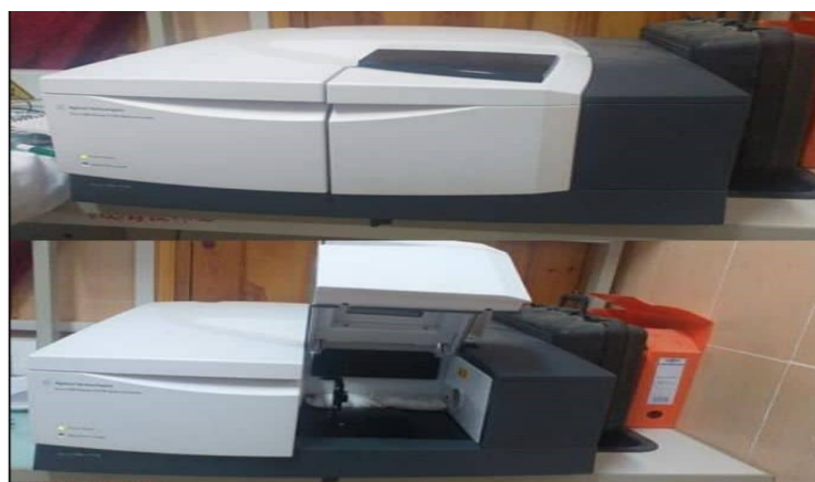
Figure III. 8: Spectromètre infrarouge à transformée de Fourier IRTf (Cary 660).
