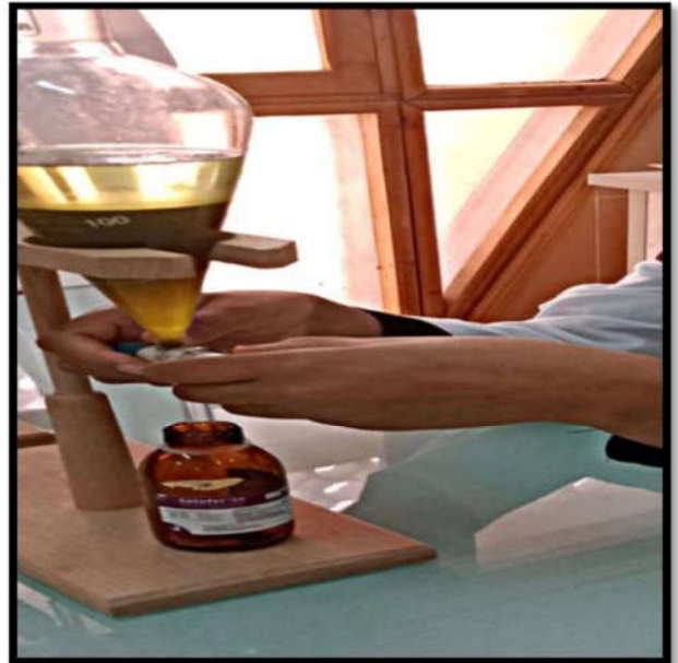
Figure 27 : Dégraissage du filtrat par le n-hexane.
