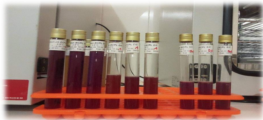
Photo N°20: Milieu BCPL pour Recherche et Dénombrement des Coliformes thermo tolérants et Escherichia coli en milieu liquide.
