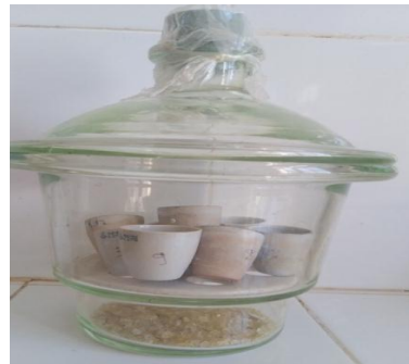
Figure 12: Échantillons dans un dessiccateur.
