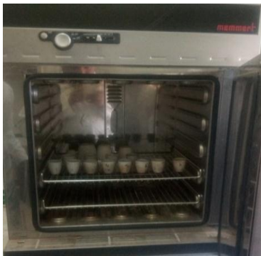
Figure 11: Échantillons dans une étuve réglée à 105^\circ\text{C} .
