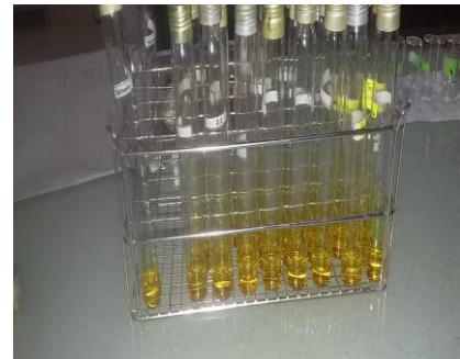
(b) : Ajout du réactif de DNS aux échantillons.
