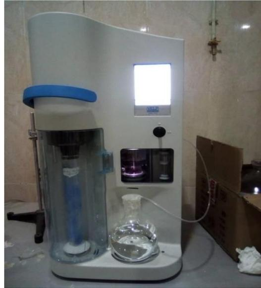
**Photo 20:** Distillation et Titrage de Kjeldahl
