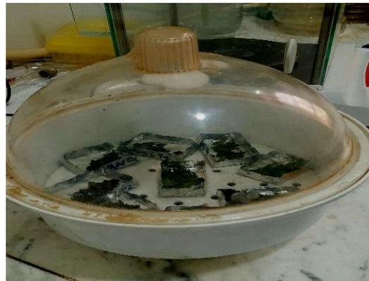
**Figure II.A.6.8.** L'échantillon dans un dessiccateur après l'étuvage à 105°C
