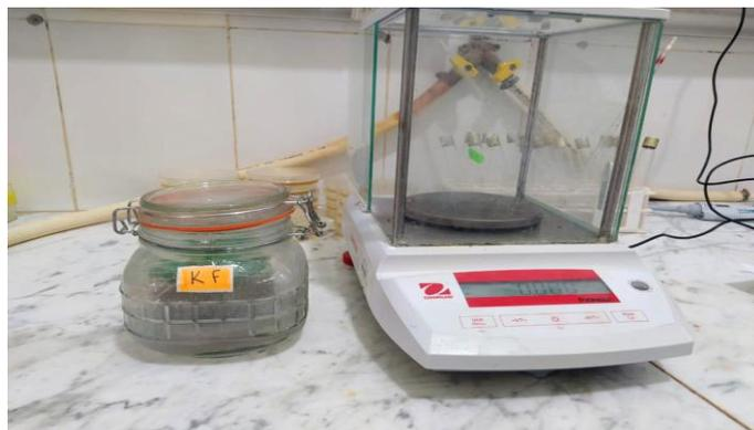
**Figure II.A.6.1.2.** Le pesage des sels et préparation des solutions salines saturées
