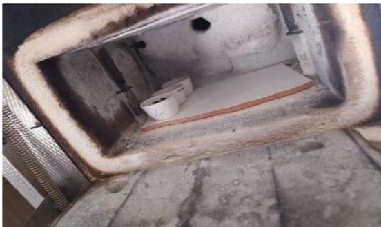
**Figure II.B.3.1.** L'échantillons dans un four à moufle
