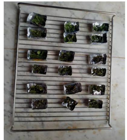
**Figure II.A.6.6.** L'échantillon à l'étuve de séchage à 105°C
