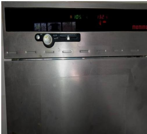
Figure II.B.2.1. L'étuve de séchage
