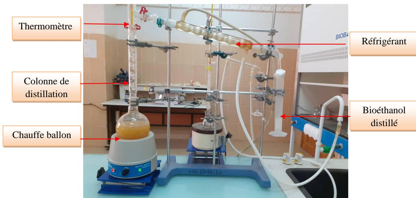
**Figure II.20:** Montage de distillation fractionnée.
