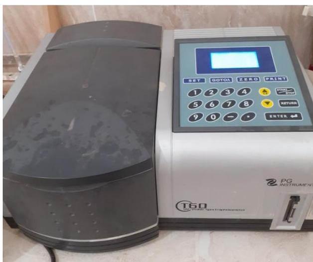
**Figure II.9** : Spectrophotomètre UV-VIS
