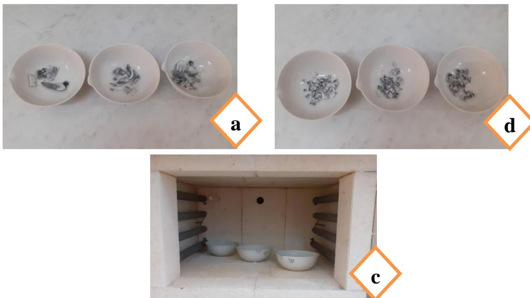
**Figure II.6 :** a): Les dattes broyé après la calcination; b):Broyé après la calcination; c):L'échantillon dans le four à moufle.
