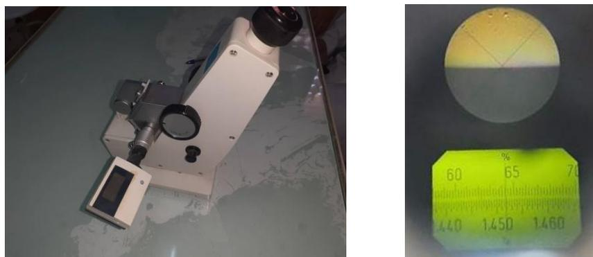
**Figure II.23:** Détermination de l'indice de réfraction à l'aide du réfractomètre
