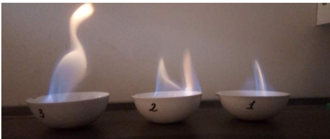
Figure III.12 : Test d'inflammabilité de l'éthanol produit
