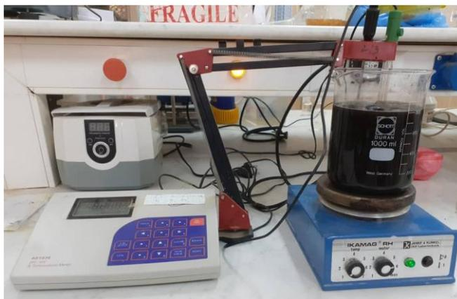
**Figure II.17:** Ajustement pH du moût
