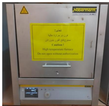
**Figure II.5:** Four à moufle utilisée
