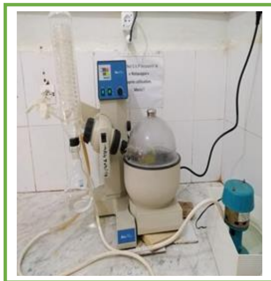
Photo III.3: Séparation d'huile de colza par rota vapeur.
