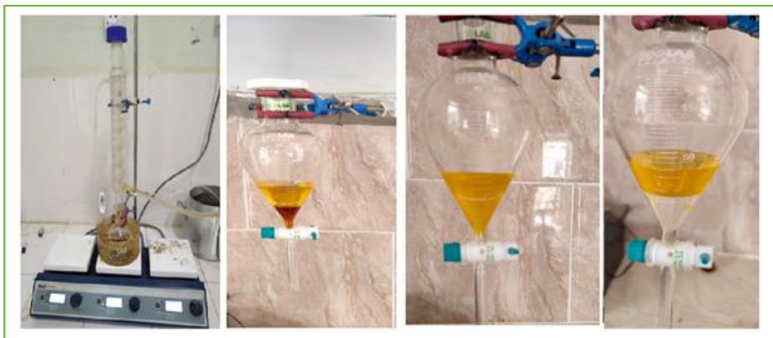
Photo III.9 : Les différentes étapes de synthèse de biodiesel.
