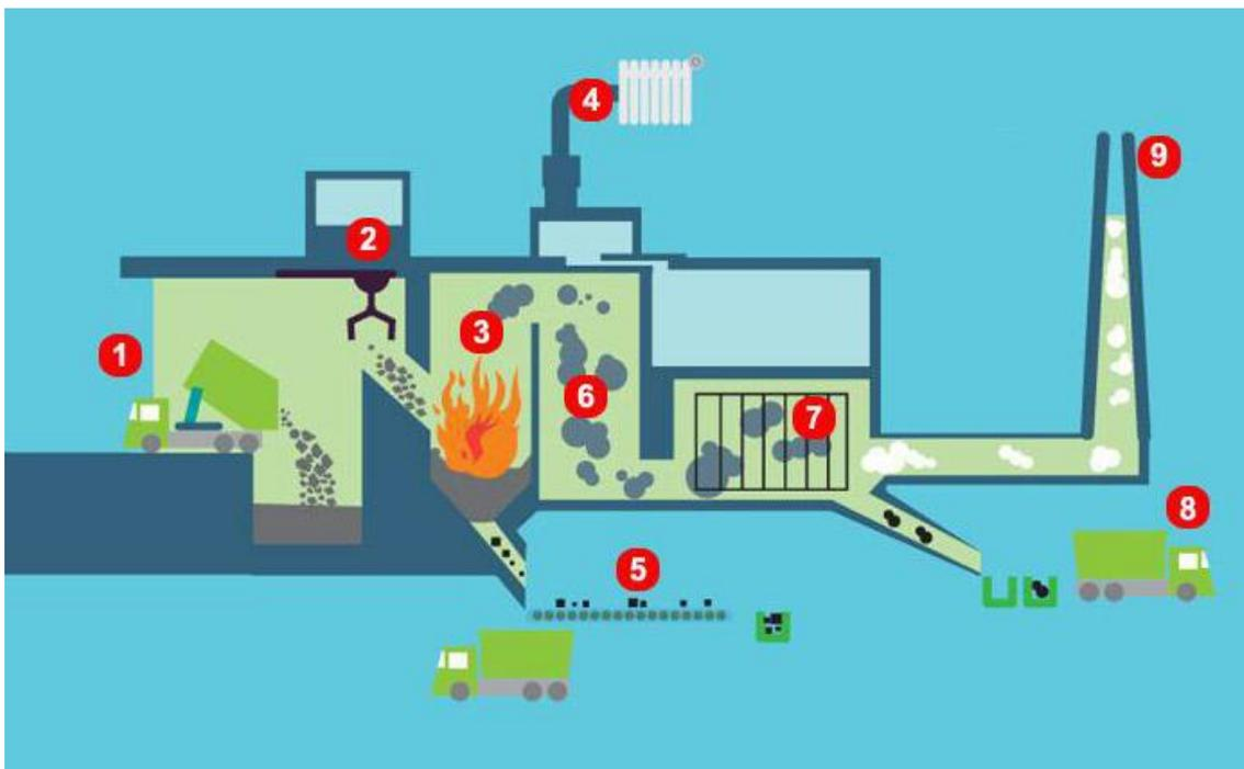
**Figure I.4 :** Schéma d'une installation d'incinération des déchets (Huang et al, 2017).
