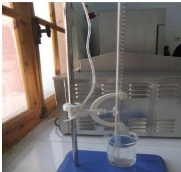
**Photo.7** : Dispositif de mesure du volume du biogaz produit.
