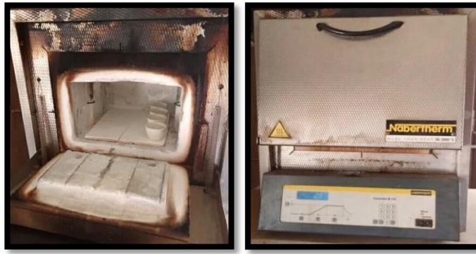
**Figure 31:** Répartition des capsules dans le four à moufle
