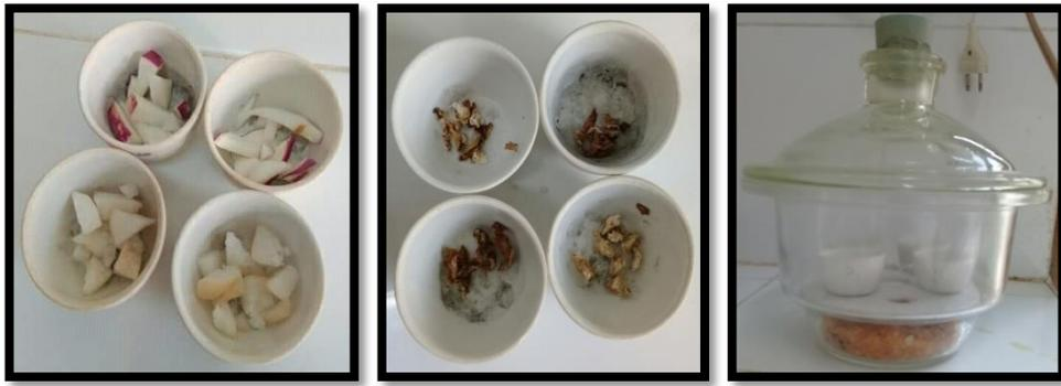
**Figure 28:** Le produit dans le dessiccateur et avant et après son introduction en étuve
