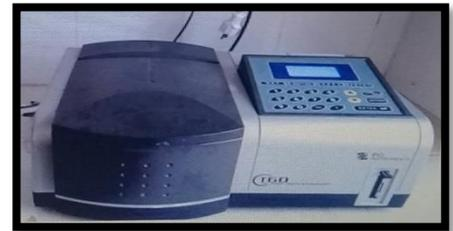
**Figure41 :** détermination du polyphénols par spectrophotomètre
