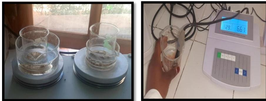
Figure 30: Détermination de PH
