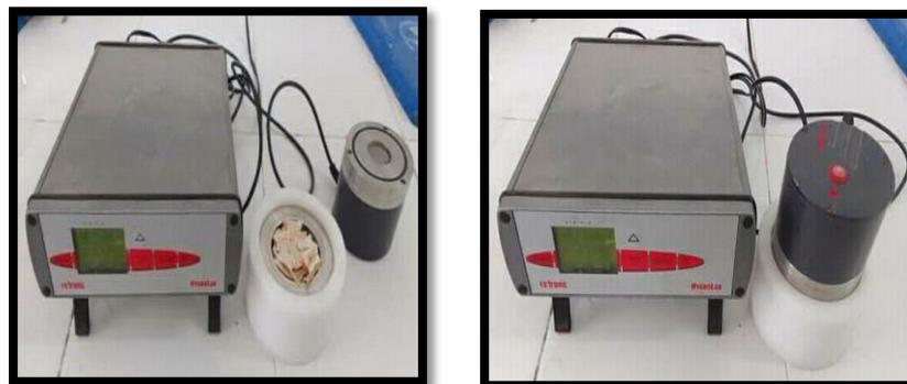
**Figure 42:** Appareil de mesure l'activité d'eau (Hygrolab)
