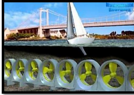
Figure 11: Le principe de la marémotrice [13]
