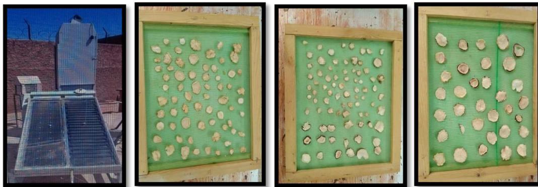
**Figure 27:** prototype d'un séchoir solaire indirect utilisé
