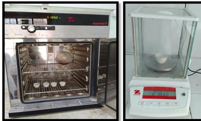
**Figure 29:** photographie de l'étuve et de la balance de précision
