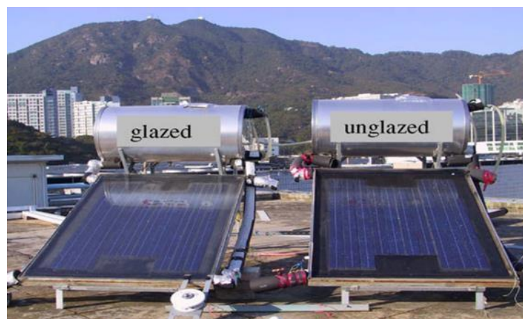
Figure.I.18 : capteur solaire hybride d'eau PVT vitré et non vitré. [22]
