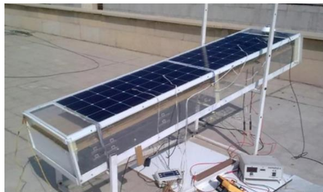
Figure.I.24 : Configuration expérimentale du collecteur d'air hybride PV/T [42].
