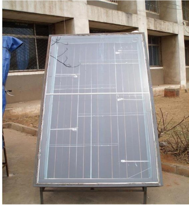
Figure III.3 : Photographie d'un capteur solaire à air [58].
