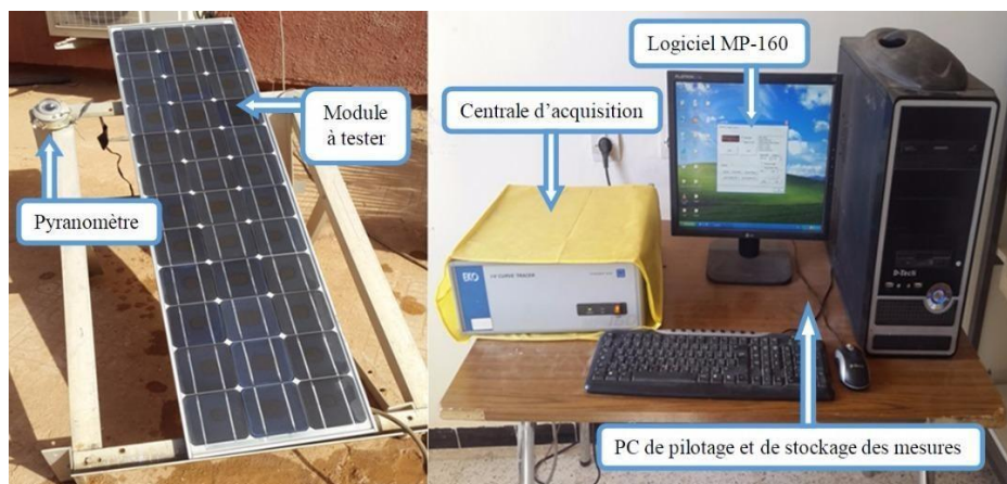
Figure III.18 : Banc expérimental pour la caractérisation de PV
