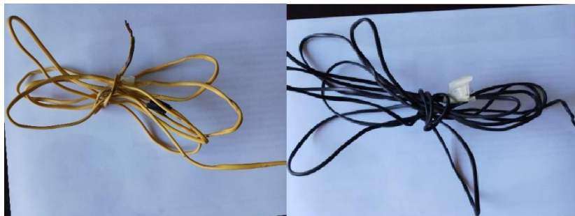
Figure.II.9 : Photographie d'instrument de mesure de température (Thermocouples de type K et J)
