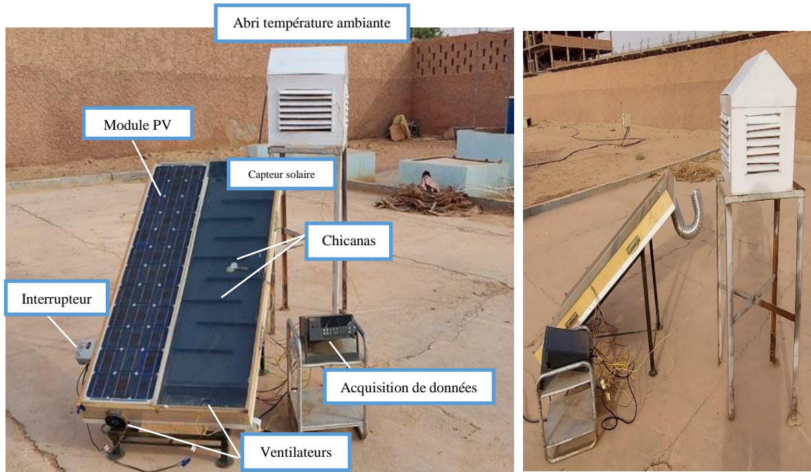
Figure III.7 : Photographie du dispositif expérimental du de capteur hybride PV/T modifié.
