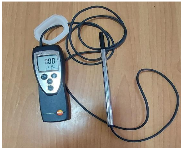
Figure II.12 : Appareil de mesure du débit de fluide caloporteur.
