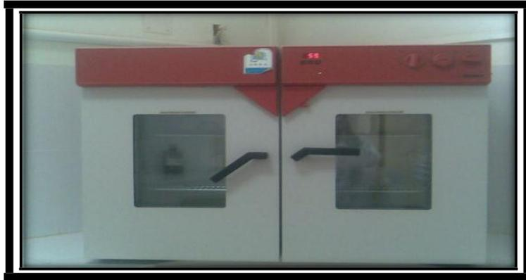
**Figure 17** Etuve, four de séchage
