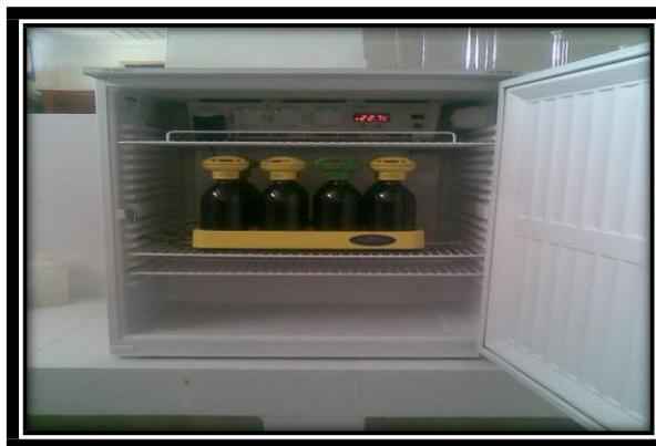
**Figure 19** DBO mètre.**✚ La Teneur en huile dans les Eaux Usées**
