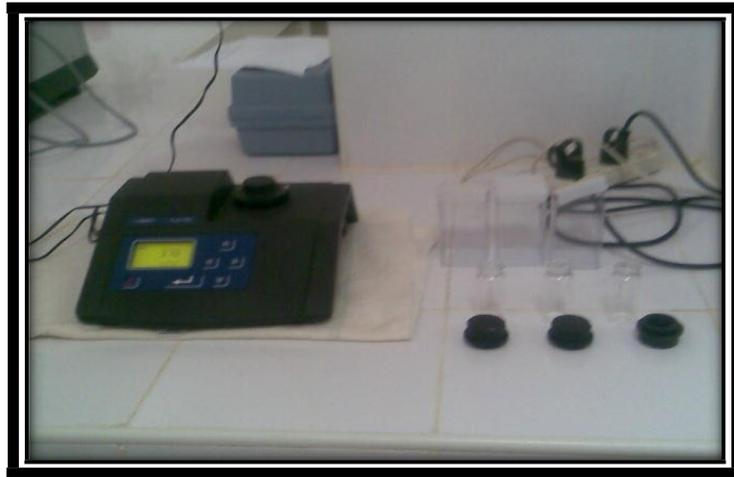
**Figure 16** Appareil de mesure de turbidité.
