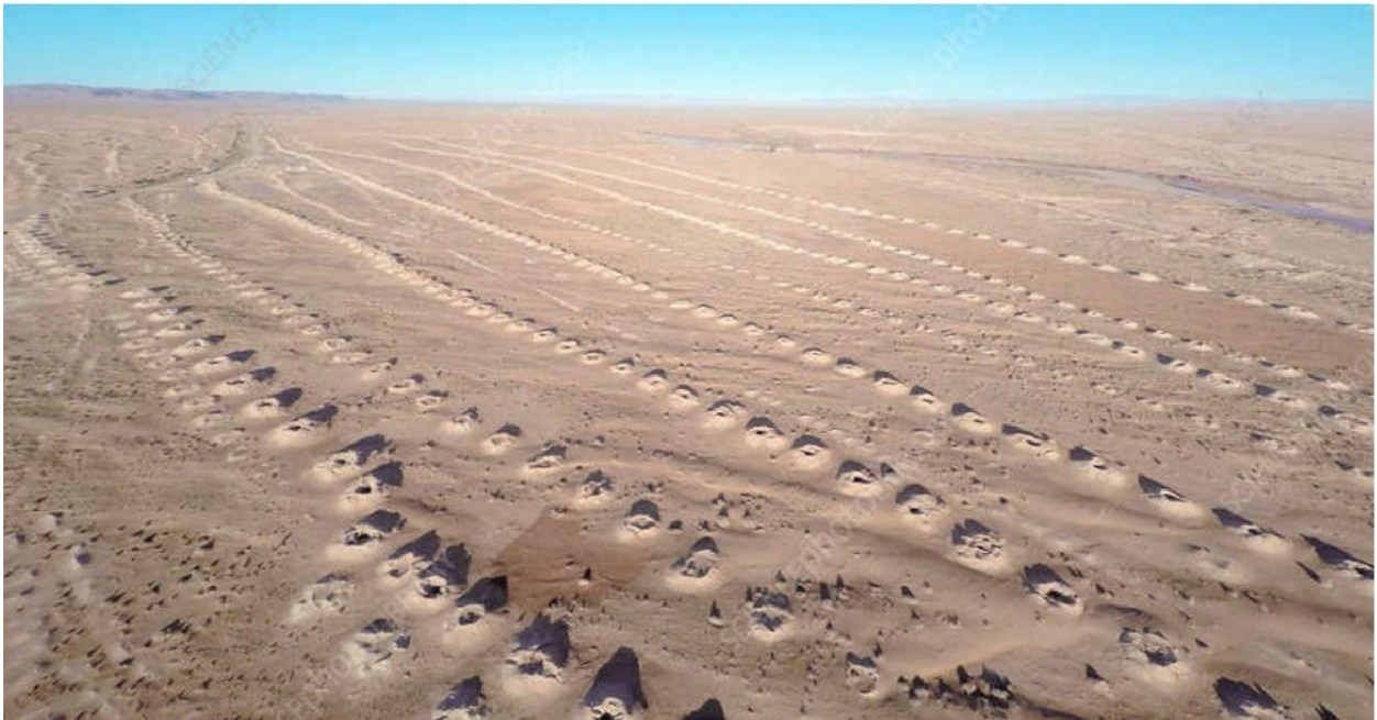
Photo 4 Alignement des cônes d'éjection de plus d'une dizaine de galeries drainantes dans la région du Tafilalet – Khetara Lahlou ha (Maroc) (11).
