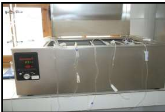
Photo III-3- Photo digesteurs émergés dans le bain marie
