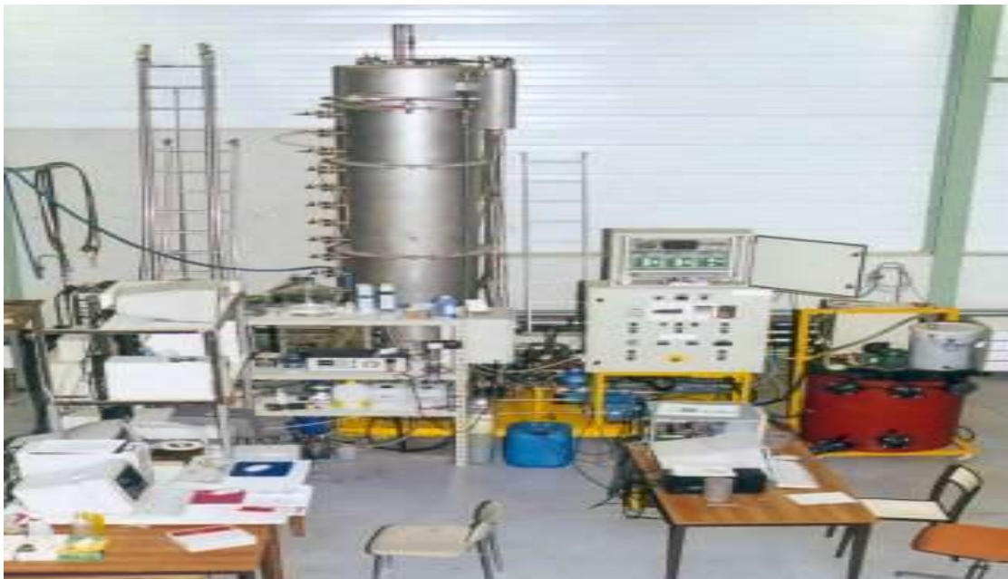
Photo II-1: Réacteur pilote et son instrumentation [24]
