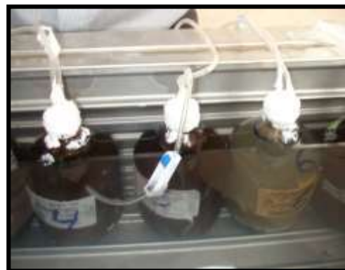
Photo III-3- Photo digesteurs émergés dans le bain marie
