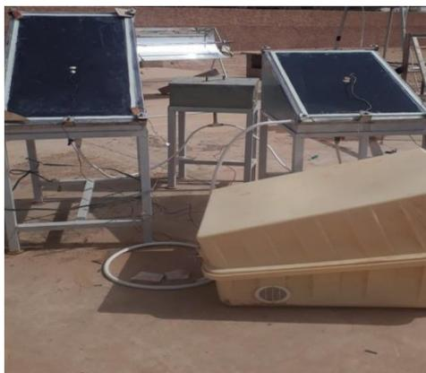
Fig III.2 : Système de dessalement deux distillateur a une seule pente
