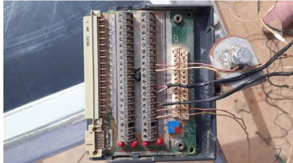
Fig III.9 : Des thermocouples (les fils noirs et jaunes)
