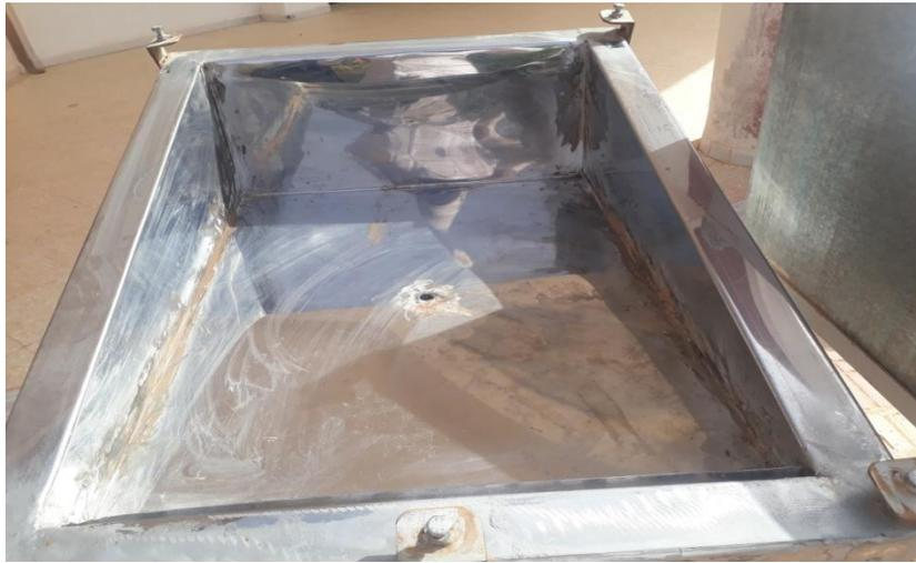
Fig III.3: Bac absorbant avant la mise de peinture
