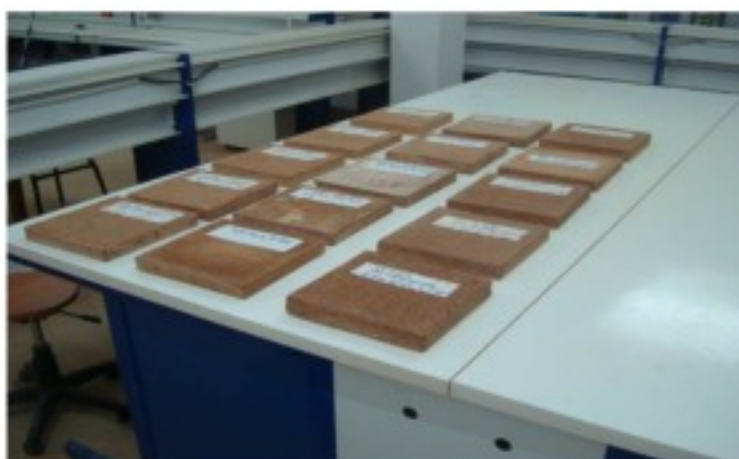
Photo III.2: Les échantillon thermiques d'adobe (auteur).
