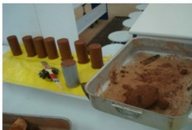
Photo III.4 : Préparation des échantillons d'adobe à la compression (auteur).
