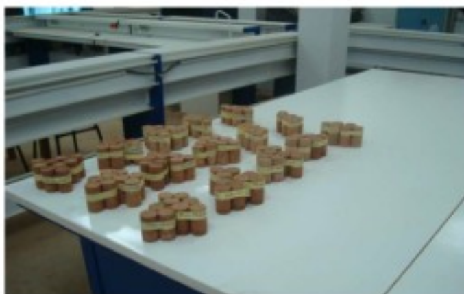
Photo III.5 : Les échantillon d'adobe à la compression (auteur).
