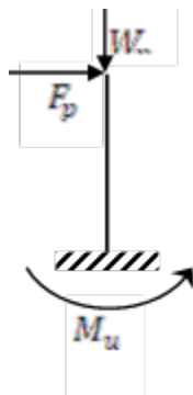
FIGURE IV.5 – Schéma statique de l'acrotère
