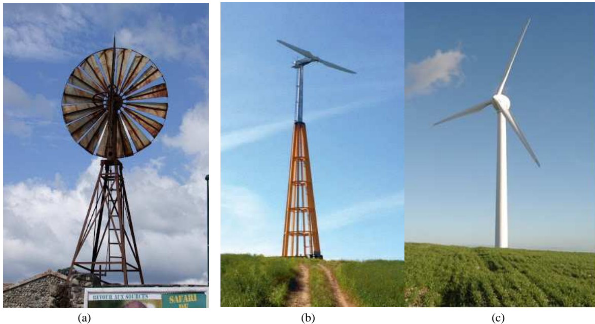
Figure I.5: Différentes technologies d'éoliennes à axe horizontal : a) Eolienne multipale b) Eolienne horizontale bipale c) Eolienne horizontale tripale
