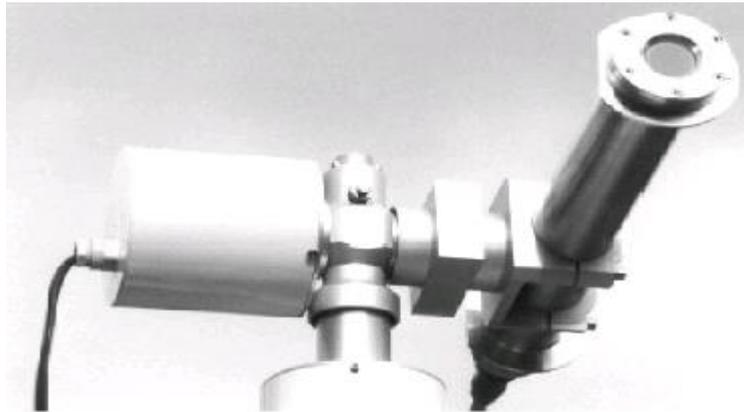
Figure (I.24) Pyrhéliomètre [20].
