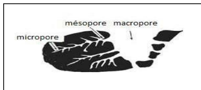
Figure I-4 : Représentation schématique de la structure poreuse du charbon actif.
