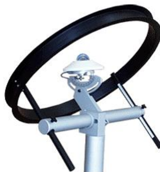
Fig. I.15 : l'instrument qui mesure le rayonnement diffus
