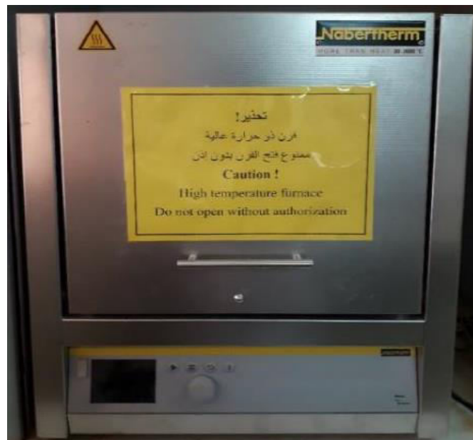
Figure II.5. : Four à moufle utilisée (NABERTHERM L1/12 - LT 40/12)
