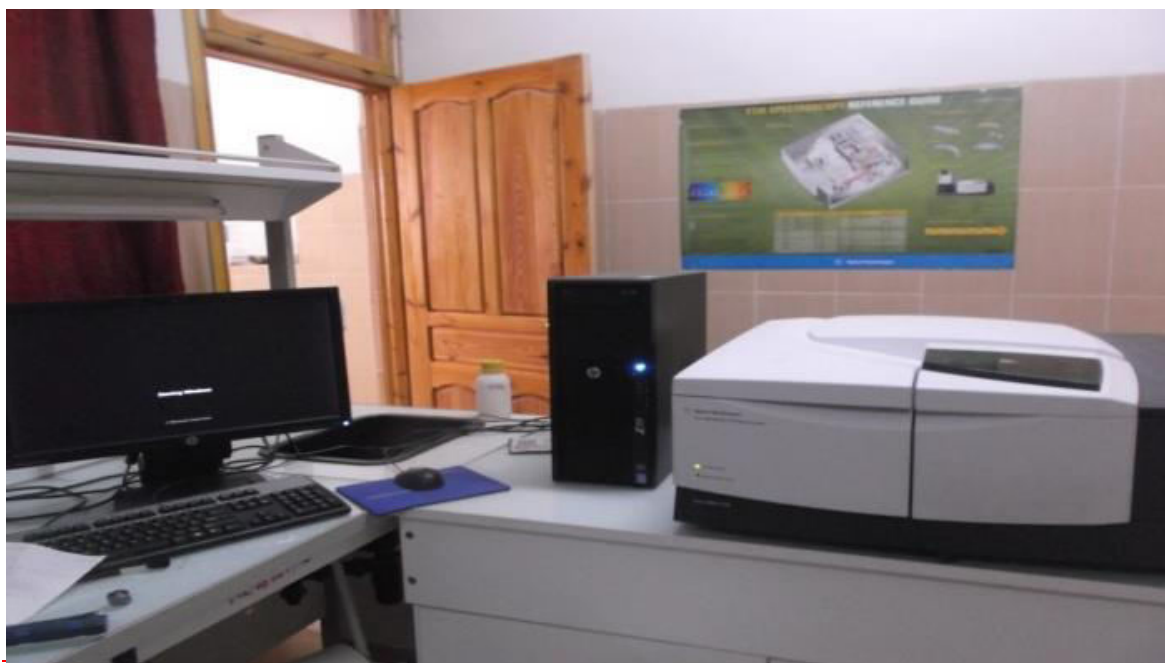
Figure II.8 : Spectromètre infrarouge à transformée de Fourier IRTF (Cary 660).
